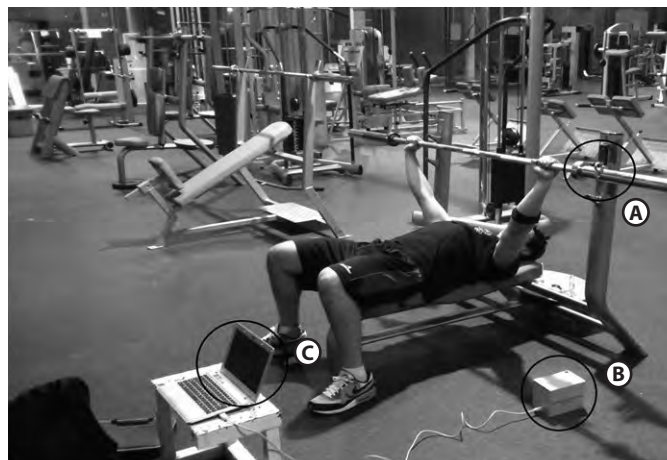
Figura 2. A. Enganche de unión entre la barra y el transductor lineal; B. transductor lineal; C. portátil.
